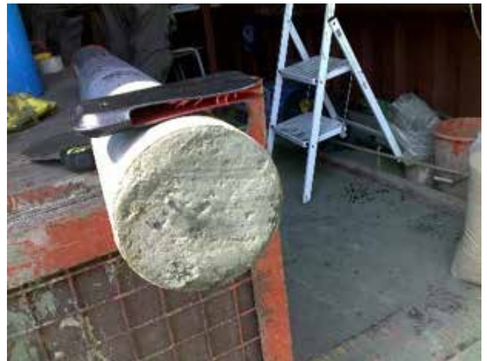
Figuur 1: Foto's van getrokken kleikernen in Borsele in 2011; zwart hoesje heeft een lengte van 12.5 cm.
