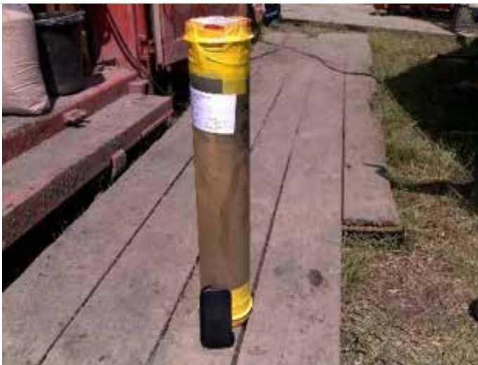
Figuur 1: Foto's van getrokken kleikernen in Borsele in 2011; zwart hoesje heeft een lengte van 12.5 cm.
