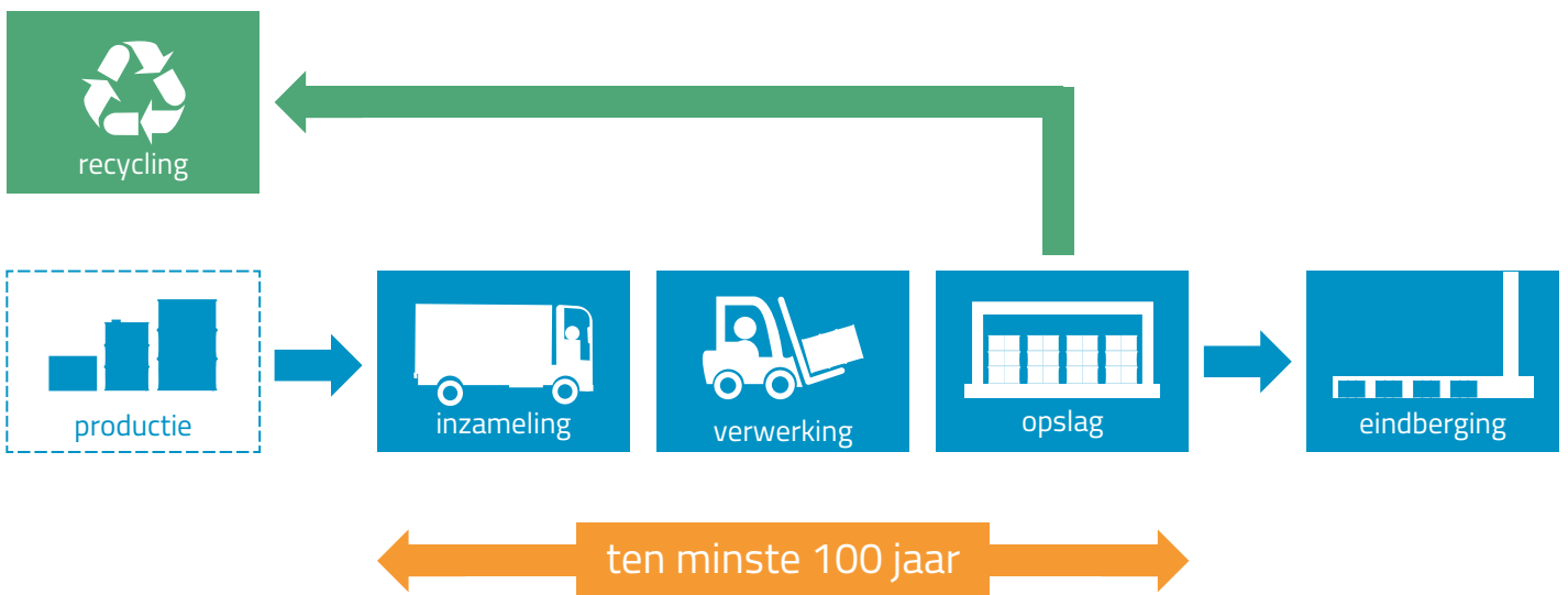
Figuur 1: COVRA is actief in de hele keten van beheer van radioactief afval nadat het is ontstaan. De afvalproducent is verantwoordelijk voor minimalisatie; COVRA kan hierin adviseren.
